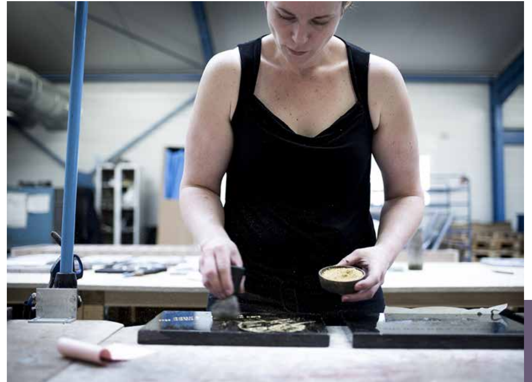
La pose de la feuille d'or 22 carats se fait au blaireau, outil traditionnel des doreurs. La poussière d'or est ensuite récupérée pour venir compléter la dorure et assurer un fini impeccable.
