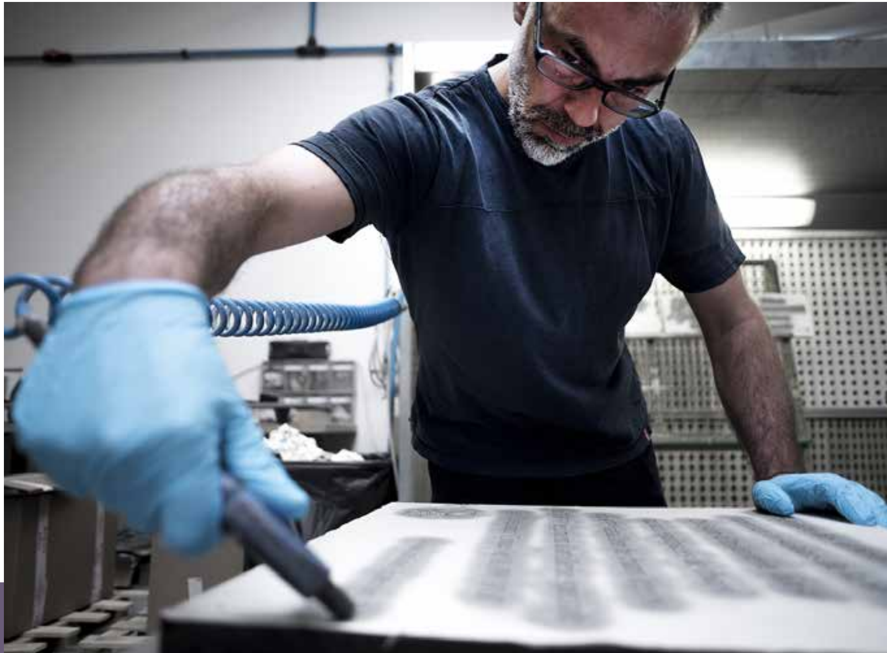
Après sablage, la plaque doit être dépoussiérée pour être prête à recevoir l'apprêt nécessaire à la pose de la feuille d'or.
