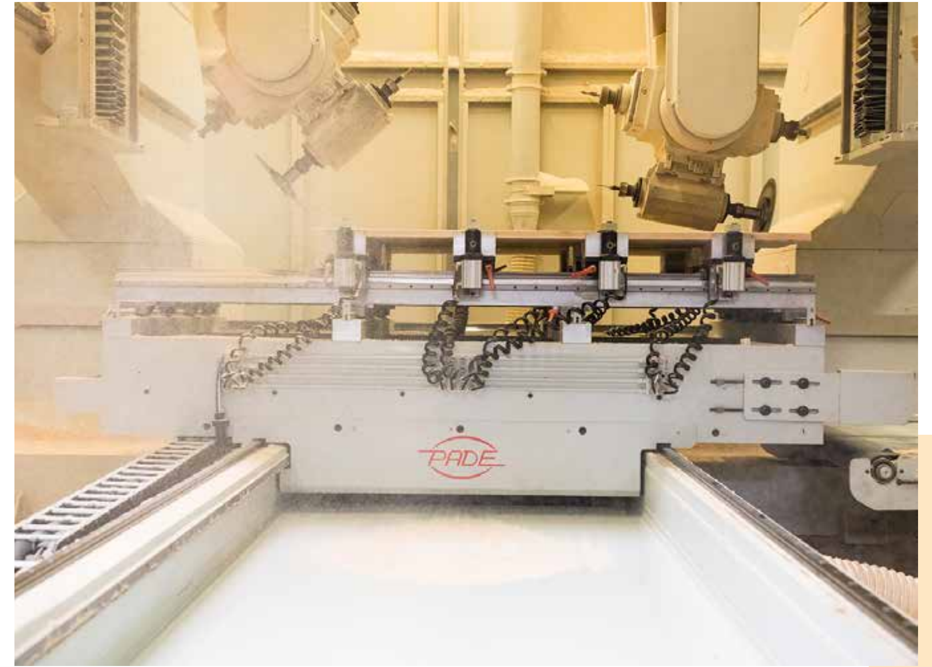
Une coupe d'onglet ainsi qu'un rainurage précis sont faits afin de préparer les différentes pièces pour l'assemblage.
