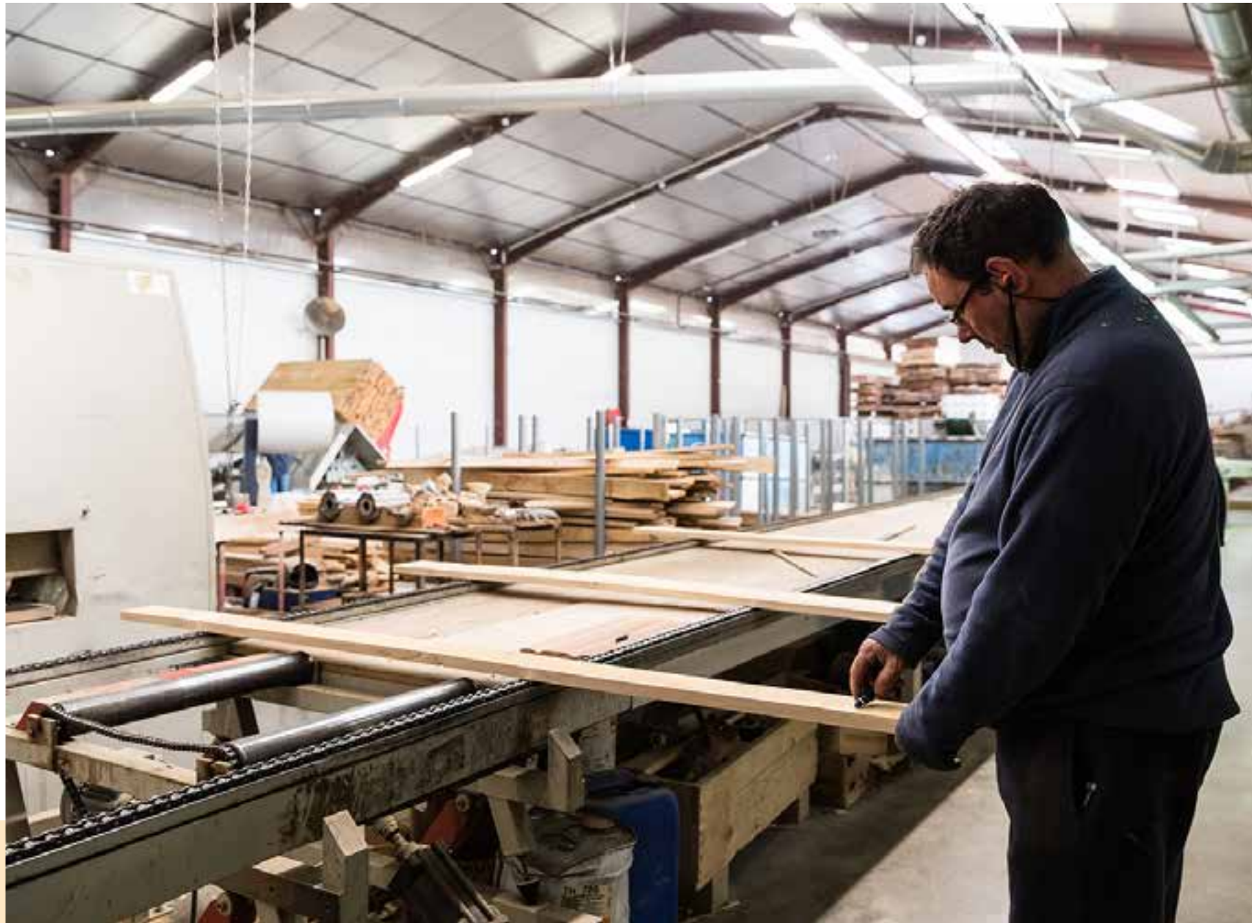
Les planches sont ensuite triées en fonction de la qualité des bois par un menuisier expert. Elles seront ensuite collées les unes aux autres pour en faire des panneaux homogènes.
