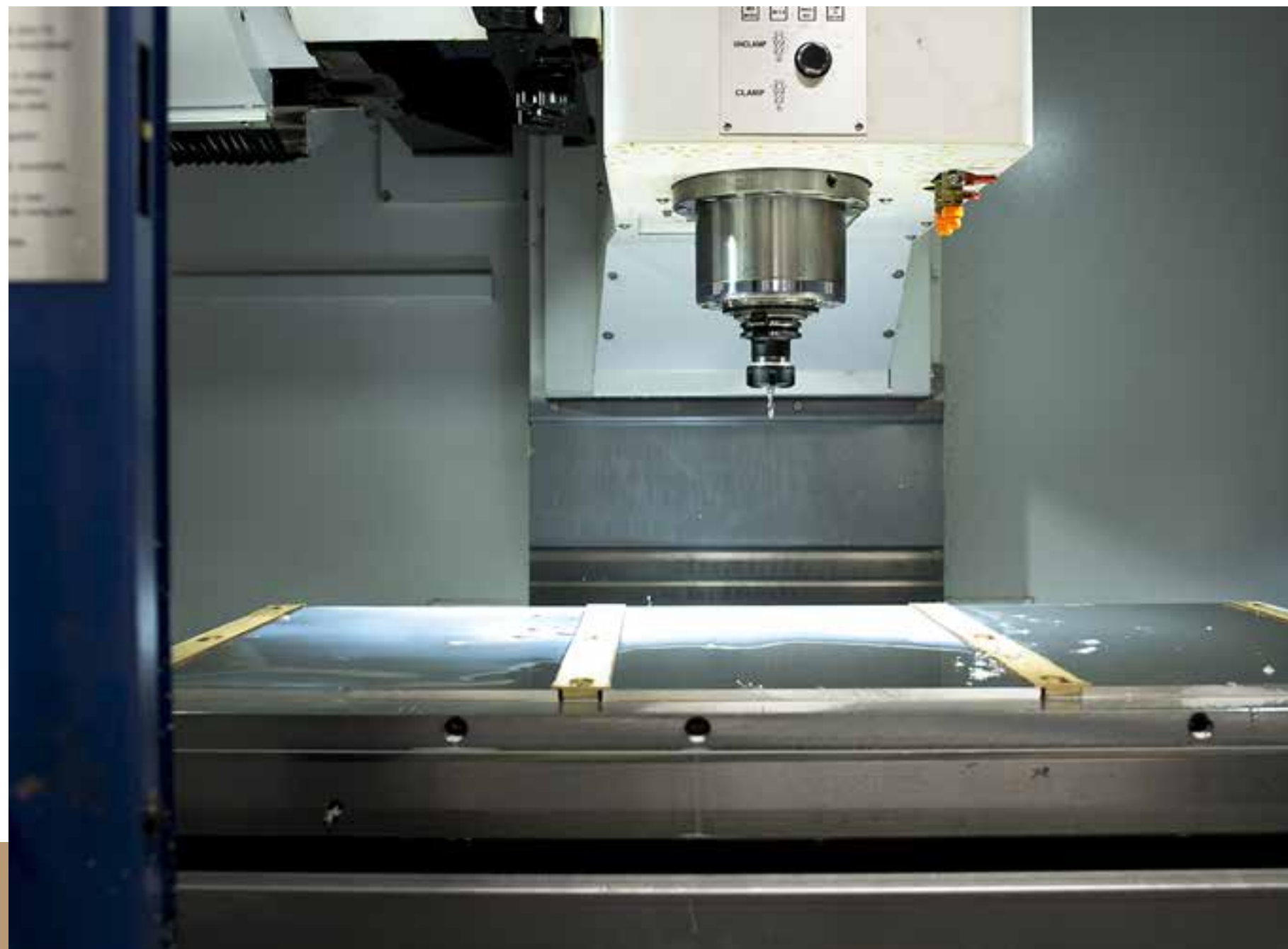
Les machines de découpe numérique sont préparées avant et nettoyées minutieusement après chaque cycle de découpe par du personnel qualifié.
