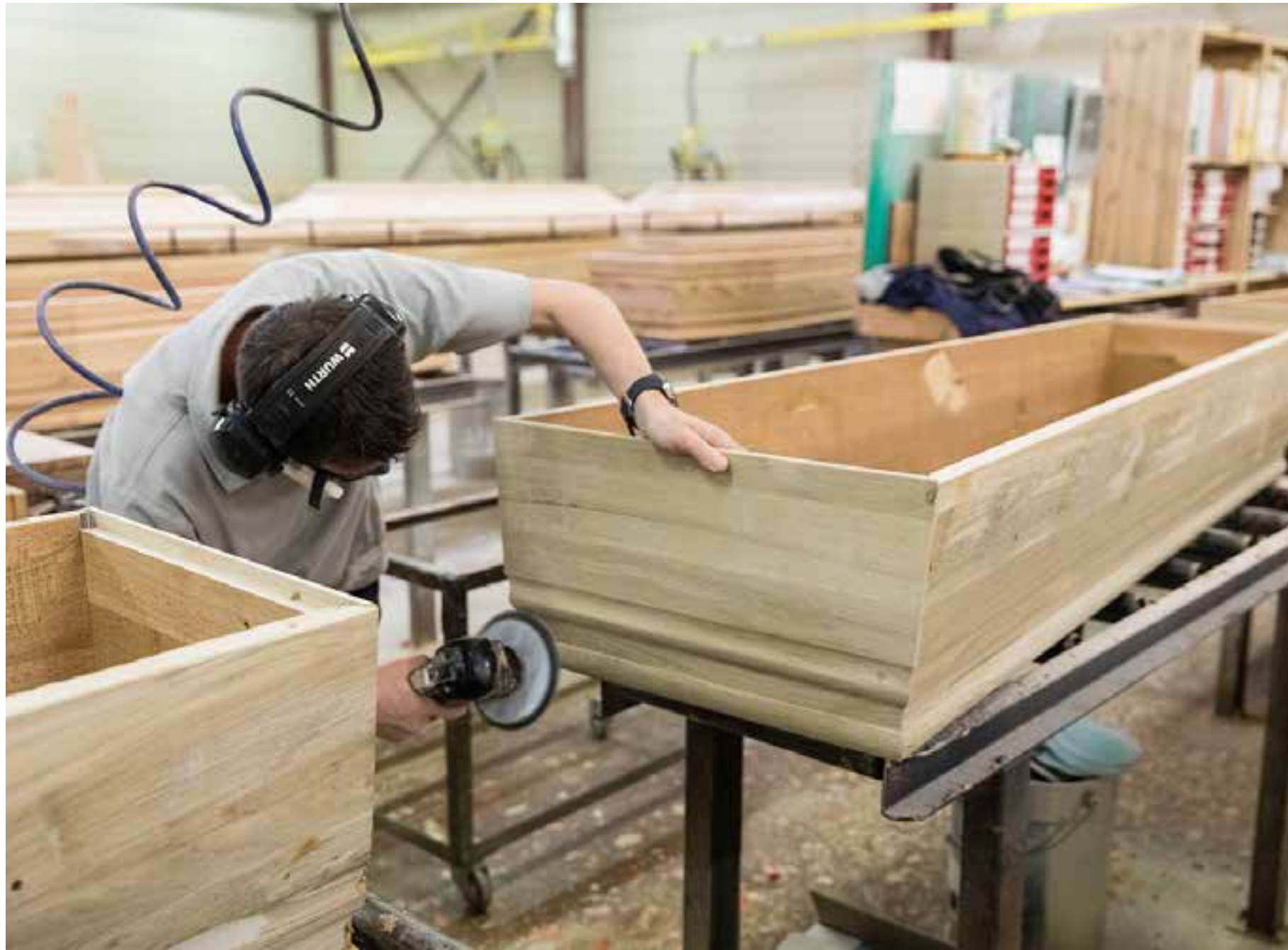
Une fois assemblés, les angles sont soigneusement façonnés. La ponceuse serait insuffisante sans le savoir-faire de l'opérateur.
