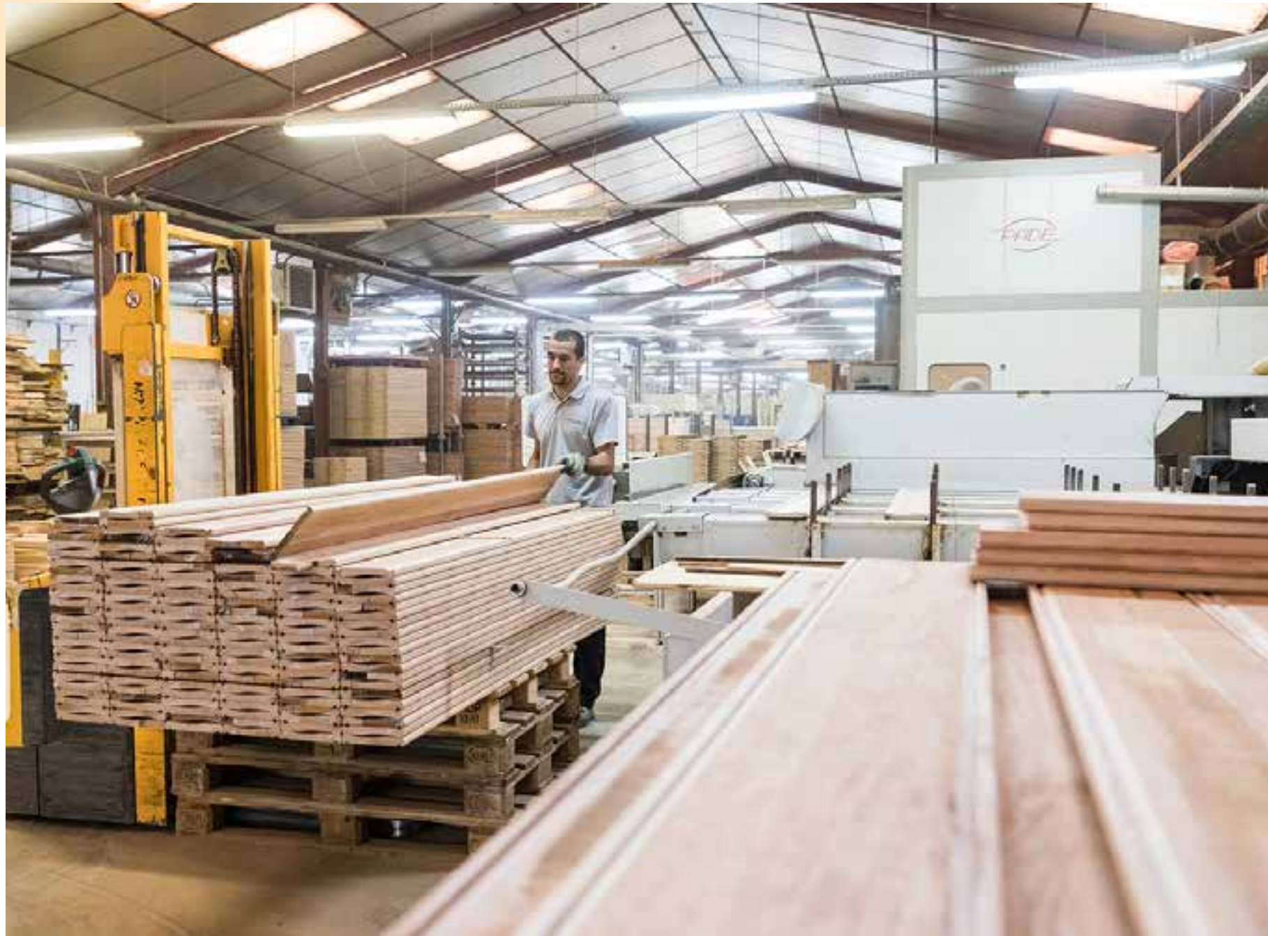
Elles sont ensuite tronçonnées pour constituer les différents éléments formant les cercueils.
