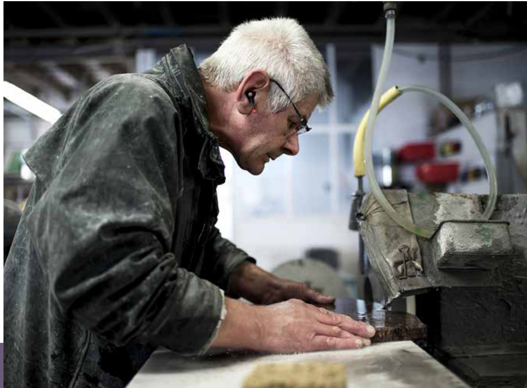
Les meules lapidaires sont encore utilisées pour polir les coins rentrants des formes complexes (cœur, nuages, etc.) avec une gestuelle adaptée.
