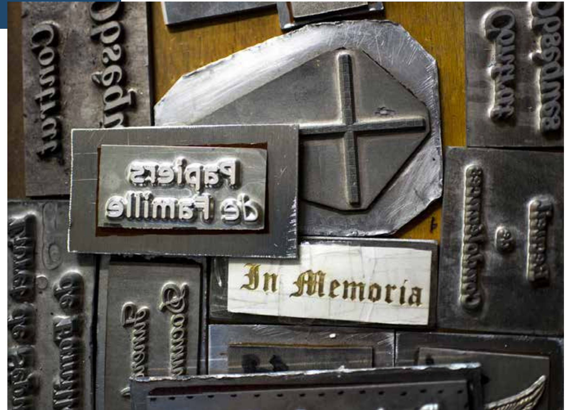
Modèles de clichés (fer à dorer) pour les impressions à chaud.
