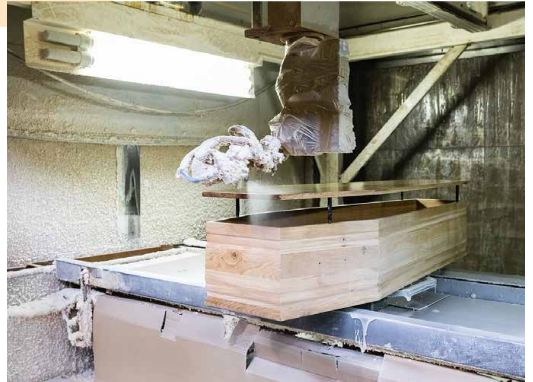
Une première couche de vernis est appliquée à l'aide d'un robot.
