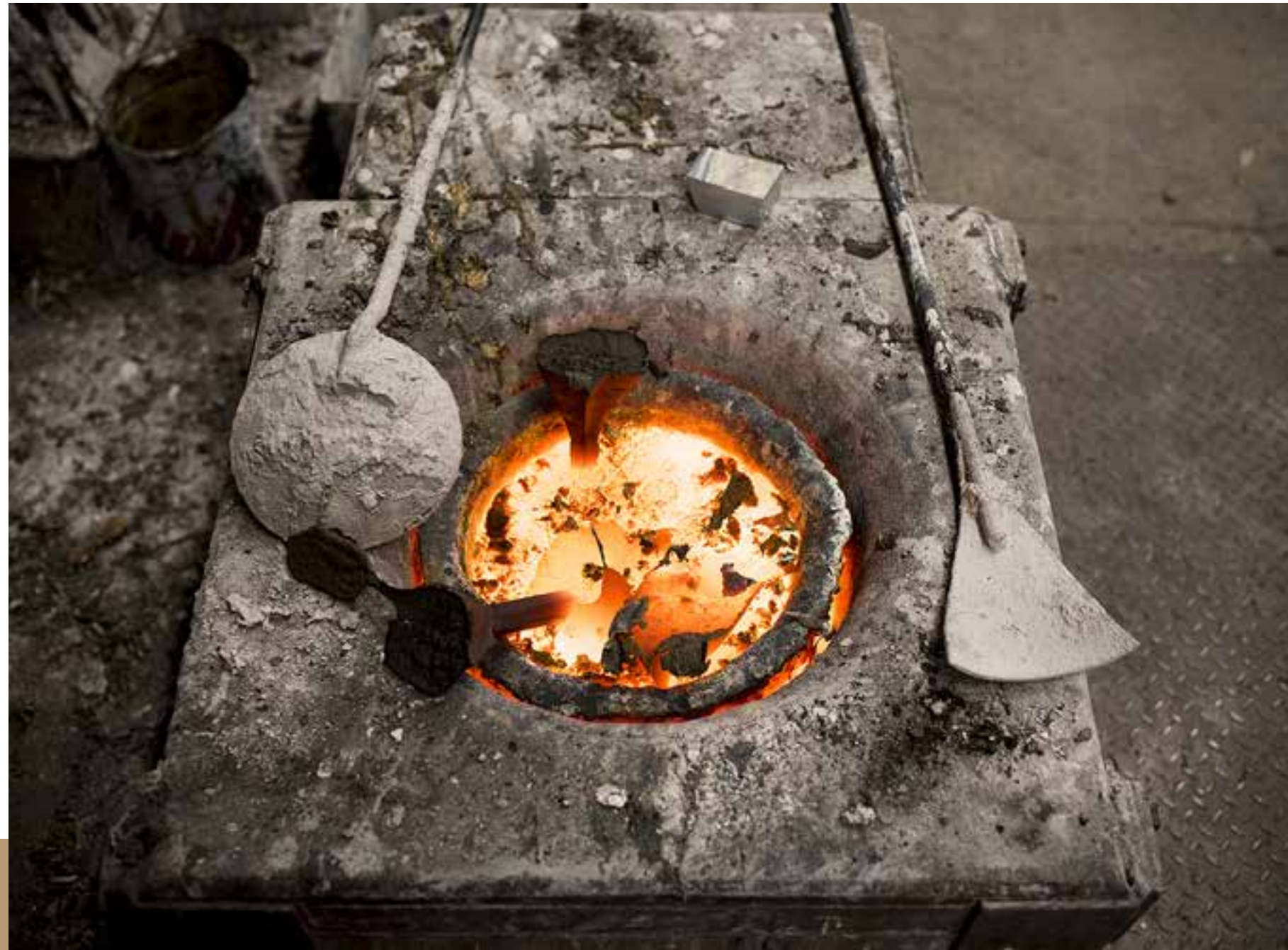
Les lingots de bronze sont fondus dans un creuset placé dans un four en les chauffant à 1 150 °C.
